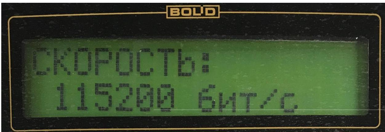
Установите такую же скорость подключения к пульту С2000М по RS-232 в конфигураторе драйвера «Бастион-2 - С2000».
